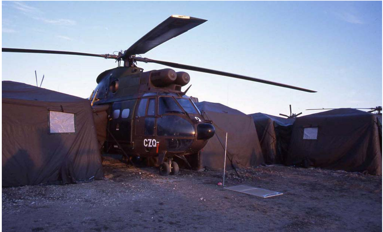
Le Puma version Poste de Commandement. Remarquer les coupe-câbles.
