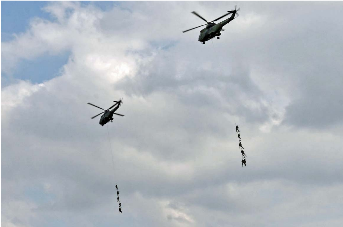
Démonstration d'une évacuation en grappe par le puits central du Puma.
