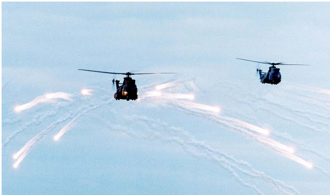
Démonstration de leurrage par le lance-leurres ECLAIR du Puma RESCO.
