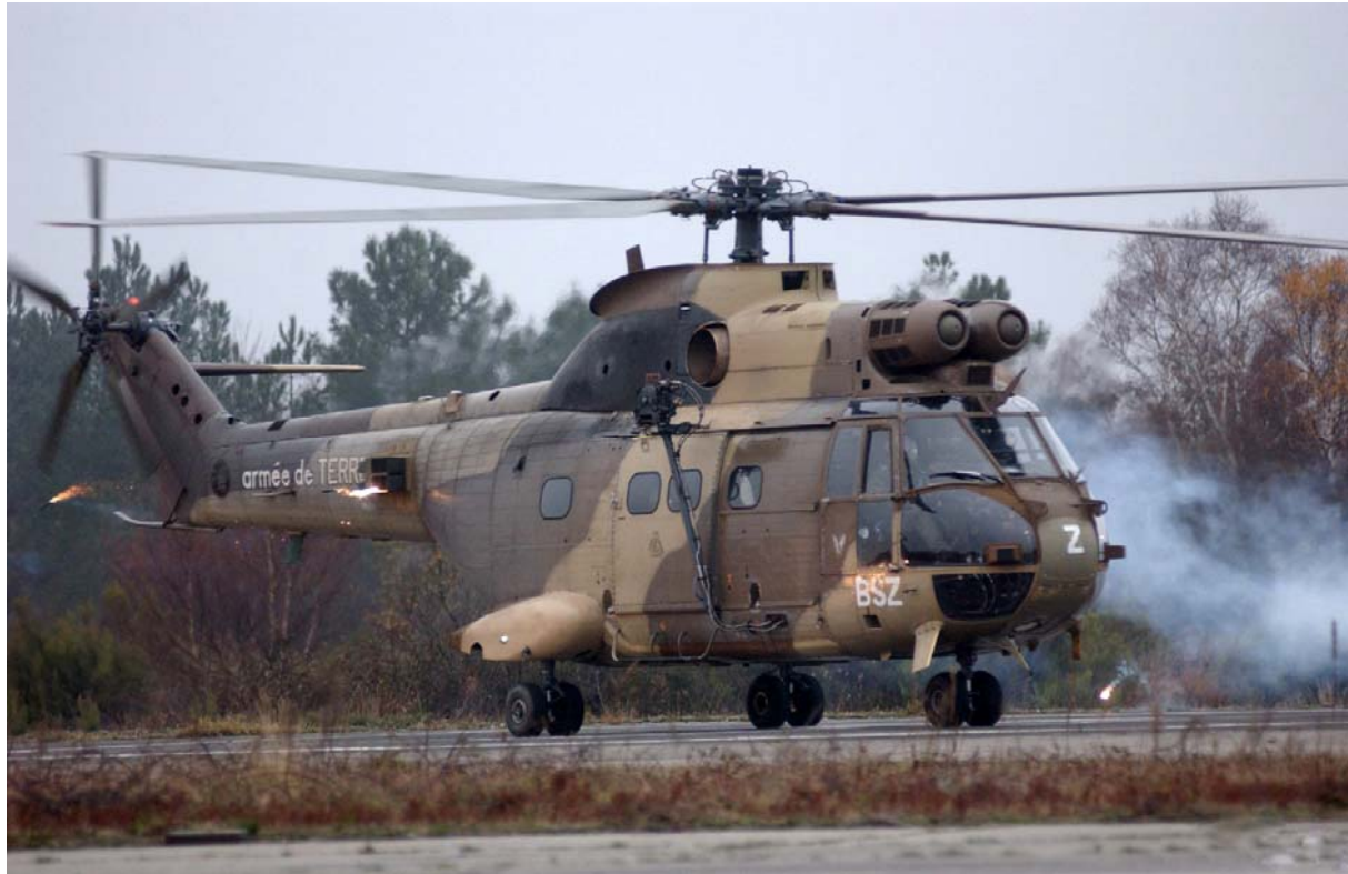
Le Puma au cours d'un essai de leurrage. Le SAPHIR A est monté sur la poutre.
