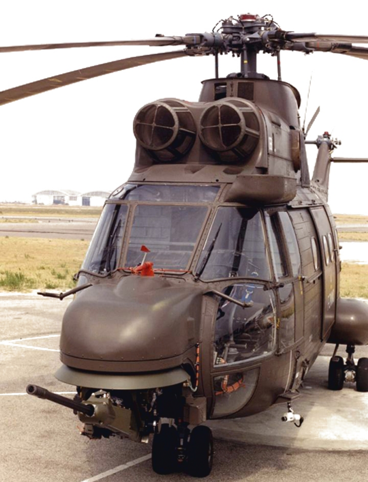
L'hélicoptère d'attaque Puma équipé du canon de 30 mm monté en tourelle de nez.
