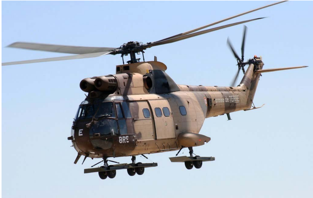
Le Puma, en camouflage désert, équipé des trois skis métalliques.
