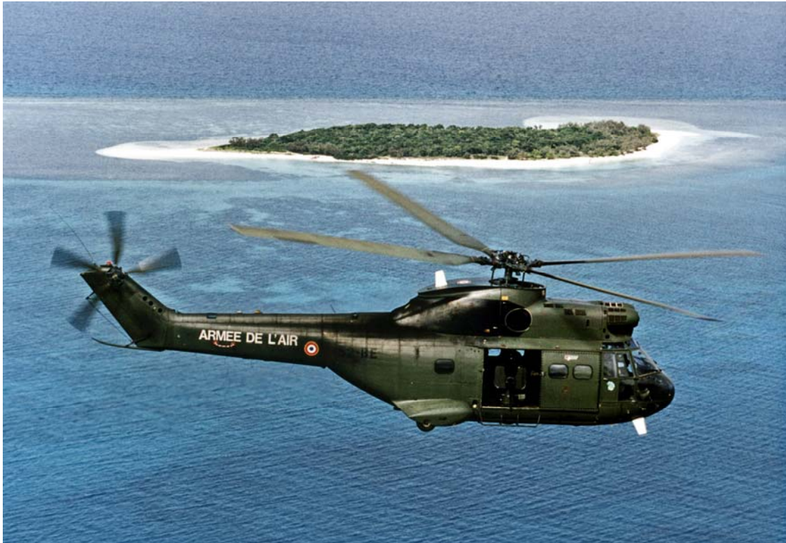
Le Puma Pirate équipé de son canon de 20 mm monté en sabord.
