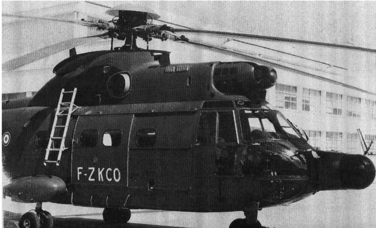
1978, un Puma de l'ALAT équipé de l'installation de dégivrage et du radar ORB 31.
