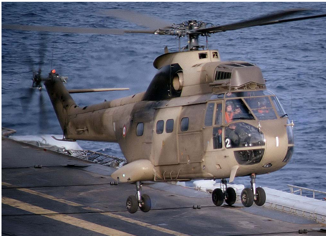
Décembre 1979, un des derniers vols d'un SA 330 B équipé du capotage anti-sable.
