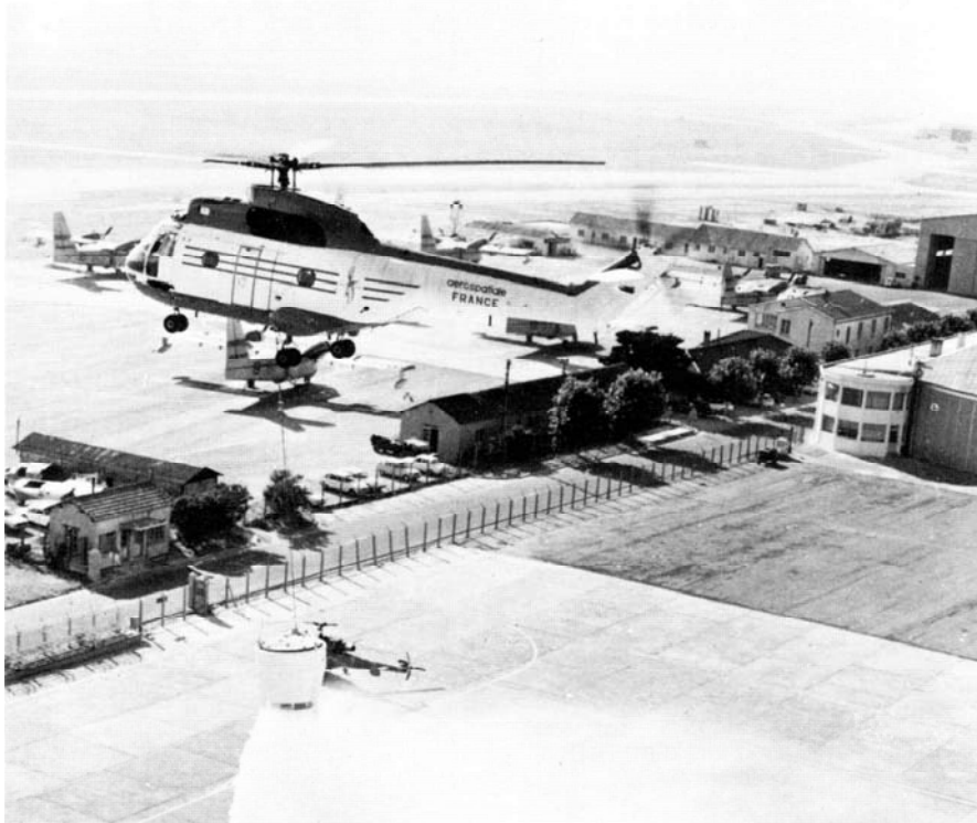
Sur le parking de Marignane en 1972, le SA 330 F N°1007 équipé du seau d'épandage Alkan d'une capacité de 1850 litres. Remarquer la porte escalier.
